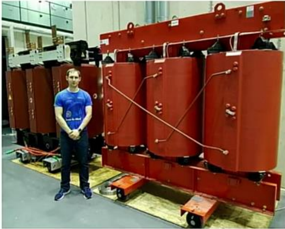
4,5 MVA, 50 Hz Transformer 11.500 kg (2,5 kg/kVA)
